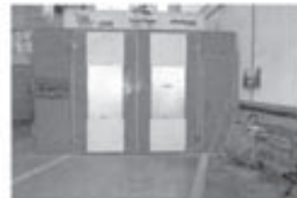
CABINA DE PINTURA Y SECADO AL HORNO
